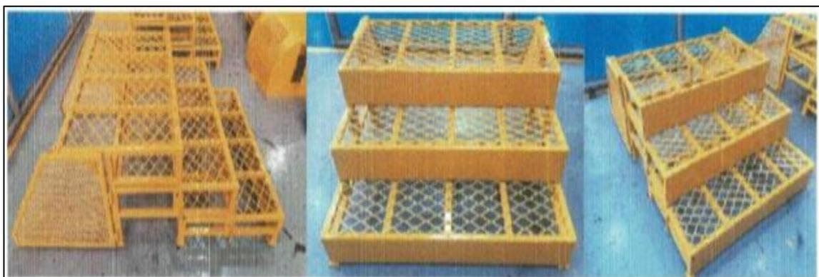
**Figura 30** - Exemplo de xemplo de acessos/escadas plataformas modulares
