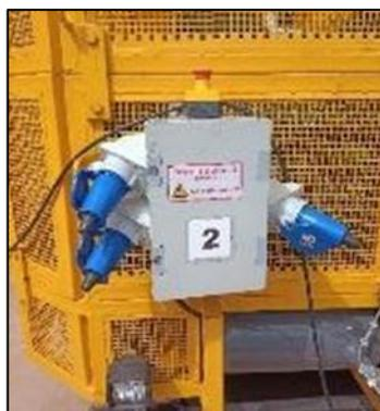
**Figura 15** - Conectores tipo steck – IP 67
