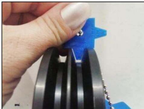
**Figura 28** - Exemplo de inspeção do gorne da roldana
