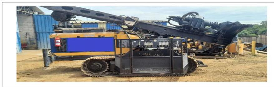
**Figura 8** - Exemplo de *proteção de esteira e plataforma de operação*
