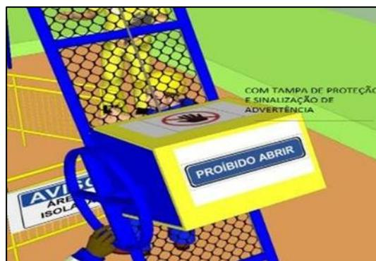
**Figura 33** - Exemplo ilustrativo da proteção da caixa do sarilho
