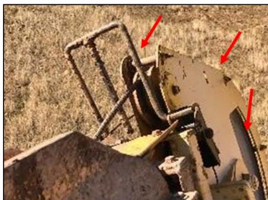
**Figura 11** - Exemplo de centralizador de cabo de aço do guincho principal na roldana
