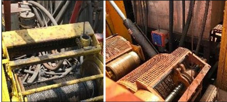
**Figura 12** - Exemplos de centralizador do cabo de aço Wireline no tambor
