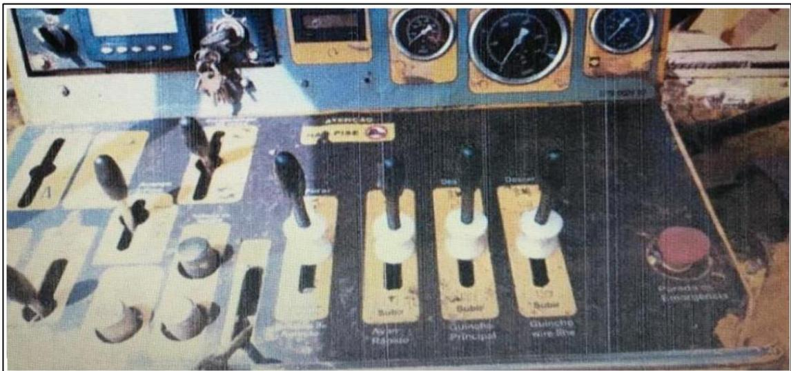
**Figura 22** - Exemplo de sistema de trava de manetes
