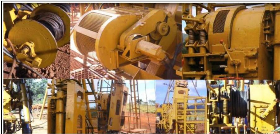
**Figura 6** - Exemplo de proteções do guincho principal e morsa inferior e superior
