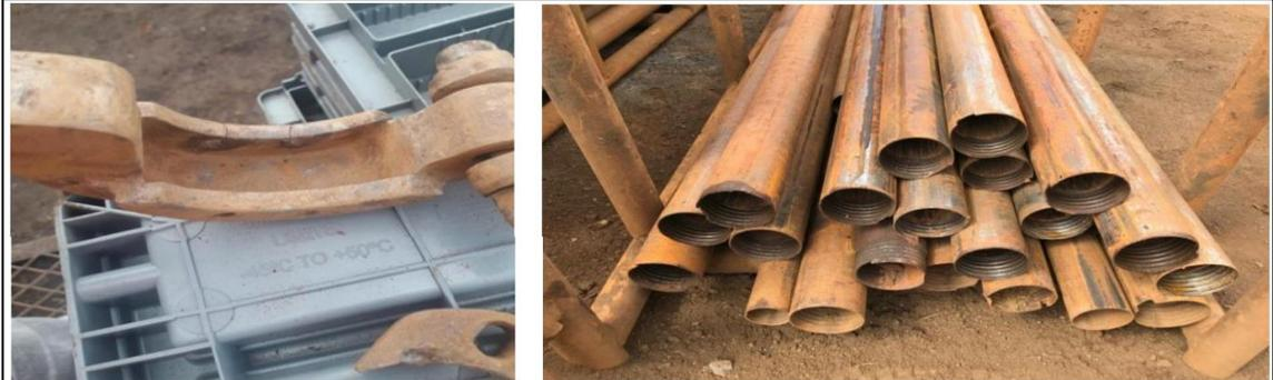
**Figura 23** - Exemplo de trinca em ferramenta e deformações em hastes
