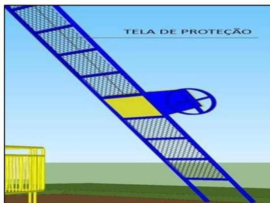
**Figura 34** - Exemplo ilustrativo de tela de proteção e volante para acionamento do sarilho
