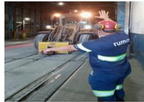
Figura 08 - Solicitando permissão do operador para passar no raio de ação máquina.
