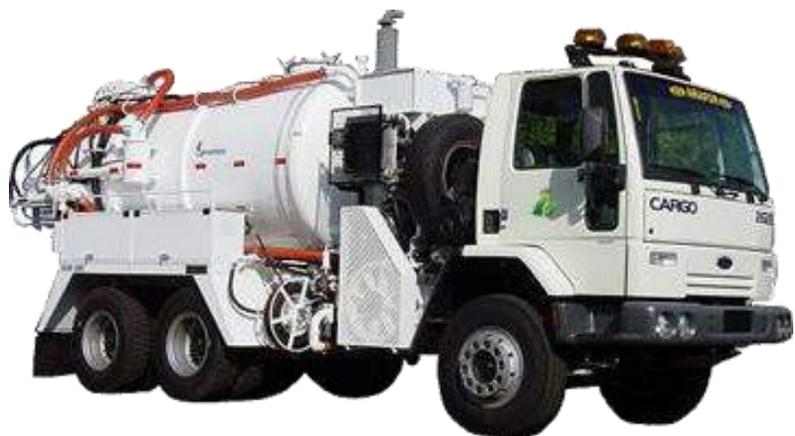
**DESCRIPTIVO:** Caminhão equipado com sistema que utiliza força de sucção, vácuo ou não, para remoção de resíduos determinados, sólido ou líquido, tubulações ou mesmo desobstrução de galerias de esgoto ou similares.
