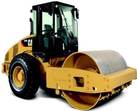
**DESCRITIVO:** Equipamento com função de diminuir e comprimir superfícies que possuem grande quantidade de solo ou resíduos. Suas aplicações são diversas e vão desde obras rodoviárias, compactando o solo para construção de vias, até a compressão de superfícies para edificações.
