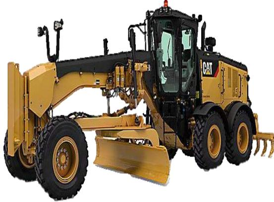
**DESCRIPTIVO:** Equipamento que serve para deslocar e nivelar uma superfície de terra. Tem uma lâmina que pode inclinar em diversas posições em relação ao seu eixo de marcha e ao plano horizontal. Sua principal função é fazer a terraplenagem de terrenos. Ou seja, nivelar determinado perímetro do solo.
