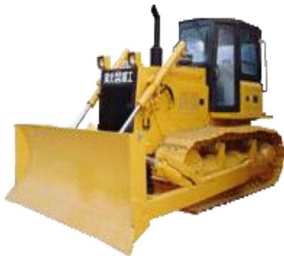
**DESCRITIVO:** Trator de esteira é um tipo de trator que se locomove através de esteiras movidas pelo sistema mecânico de transmissão. Sua finalidade é de servir para trabalhos pesados em áreas de difícil acesso e é usado principalmente para terraplenagem, escavação e ajudar no reboque de outras máquinas.
