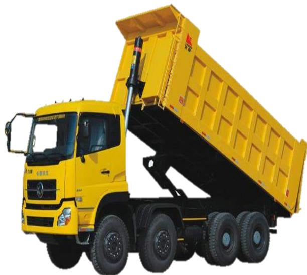
**DESCRIPTIVO:** É um tipo específico de caminhão equipado com uma caçamba articulada na parte traseira, destinado ao transporte de grandes quantidades de material
