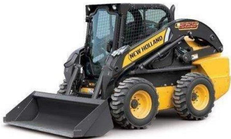
**DESCRIPTIVO:** Máquina pequena, de estrutura rígida, movida a motor com braços de elevação que pode ser conectada a uma ampla variedade de caçambas e outras ferramentas ou acessórios.
