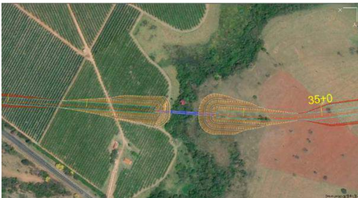
Figura 7.19 – Ponte Ferroviária sobre o Ribeirão da Fartura – Km 34+650 – ext.: 160m
