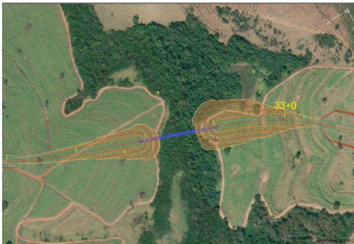
Figura 7.18 – Ponte Ferroviária sobre o Ribeirão da Fartura – Km 32+700 – ext.: 230m
