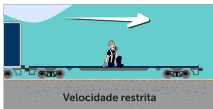
Figura 125. Recuo em vagão plataforma
