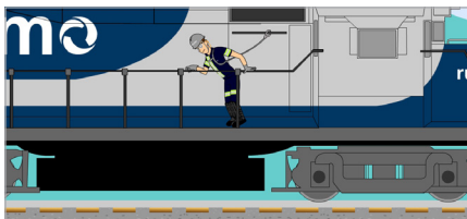
Figura 24. Viagem fora da cabine somente com corrimão, três pontos de apoio e cinto
