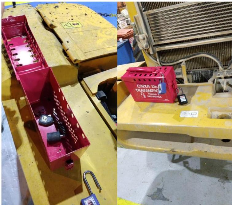
**Bloqueio elétrico do equipamento, com chave de acionamento e chave geral dentro da caixa de bloqueio, com uso dos cadeados dos executantes e líder.**
